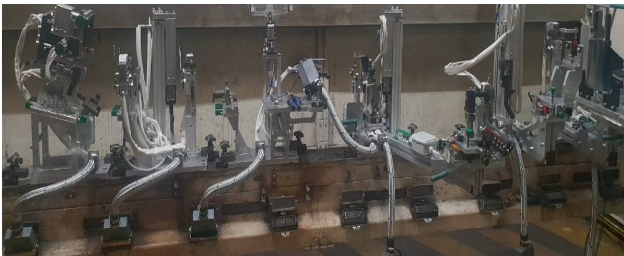
Автоматизированная оснастка для сварки системы выхлопных газов. (Реализованный проект)
